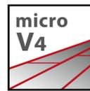
По периметру панели выполнена фаска под углом 45°. На стыке панелей образуется V-образный паз, создавая эффект настоящего массивного пола.
