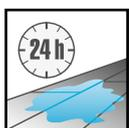
Жидкости и стоячую воду следует убирать в течение 24 часов (в соответствии с испытанием на разбухание поверхности NALFA).
