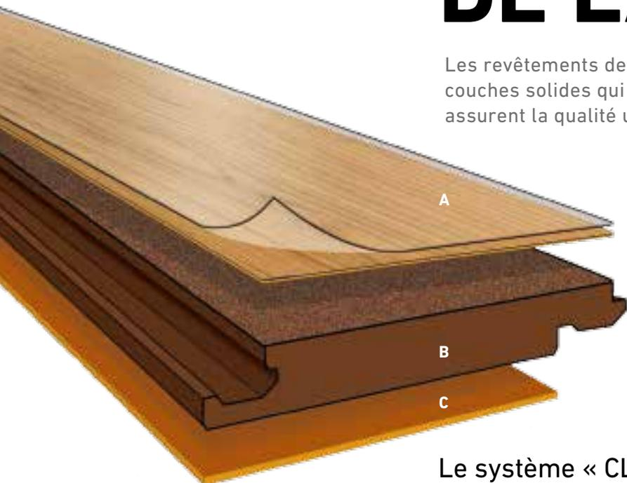
**A** La face supérieure du revêtement de sol est revêtue d'un film de protection particulièrement solide et reliée avec un film décoratif à base de résine renforçant la résistance à l'usure.
