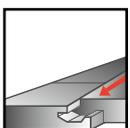
Schnelle Verlegung durch einfache Verriegelungsmechanik längs und quer.
